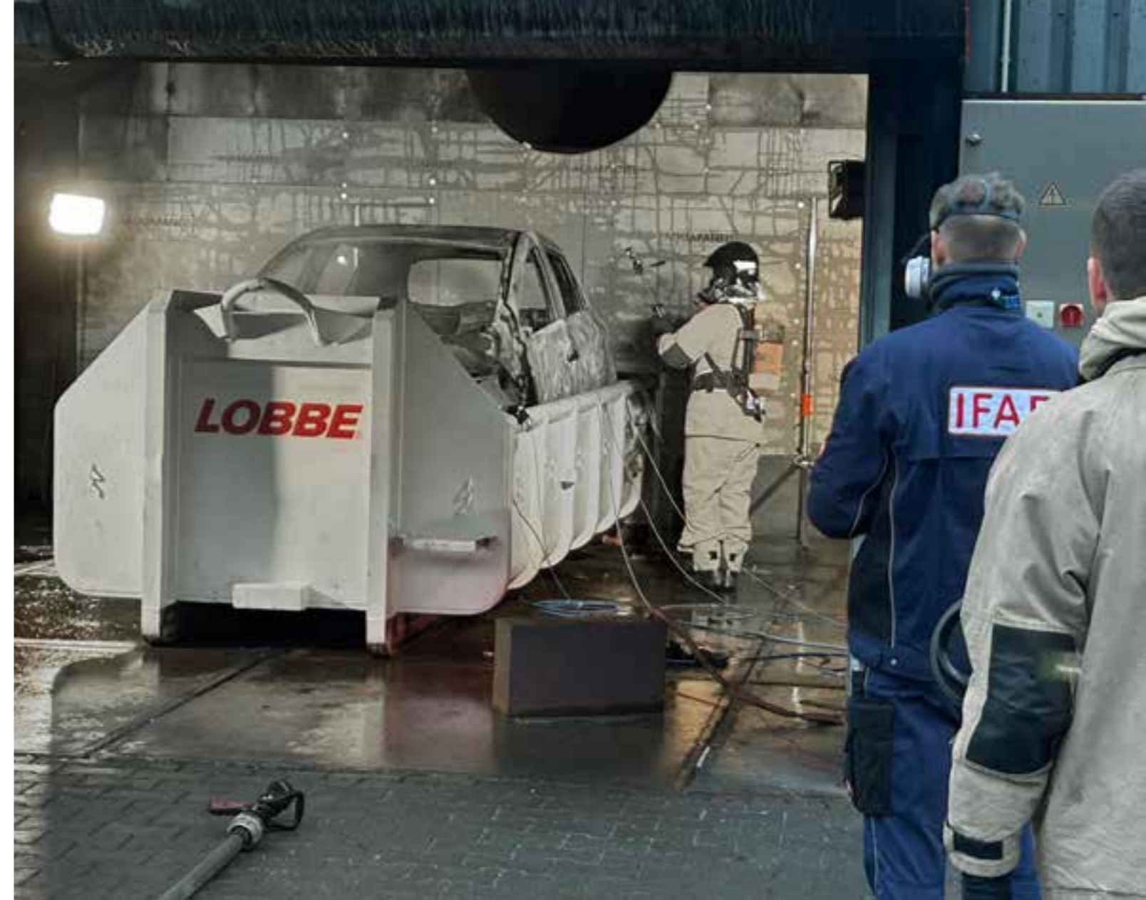
Brandversuch: In einem Versuch wurde ein E-Fahrzeug entzündet, um Daten über Emissionen, Löschwasser und Kontaminationen zu bekommen.
