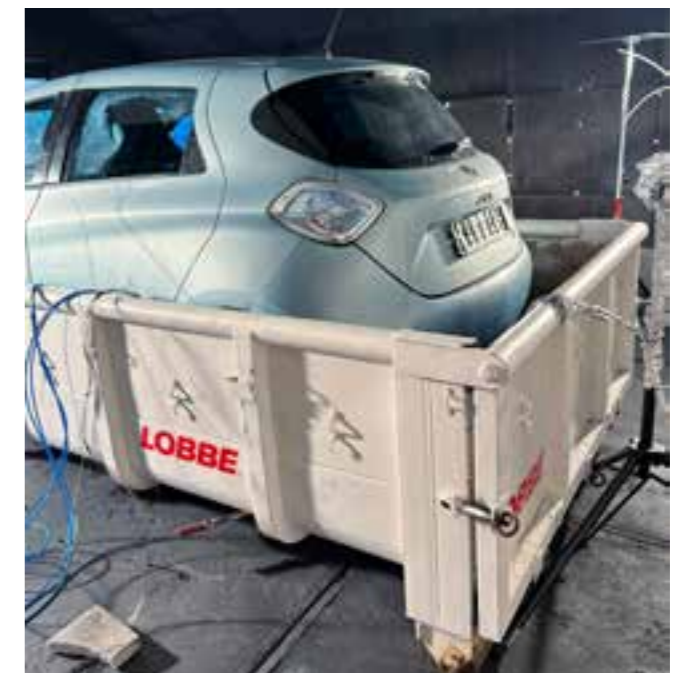
Verkabelt für den Brandversuch: Für den wissenschaftlichen Versuch werden über Sonden, Kameras und Messgeräte verschiedene Parameter erfasst.
