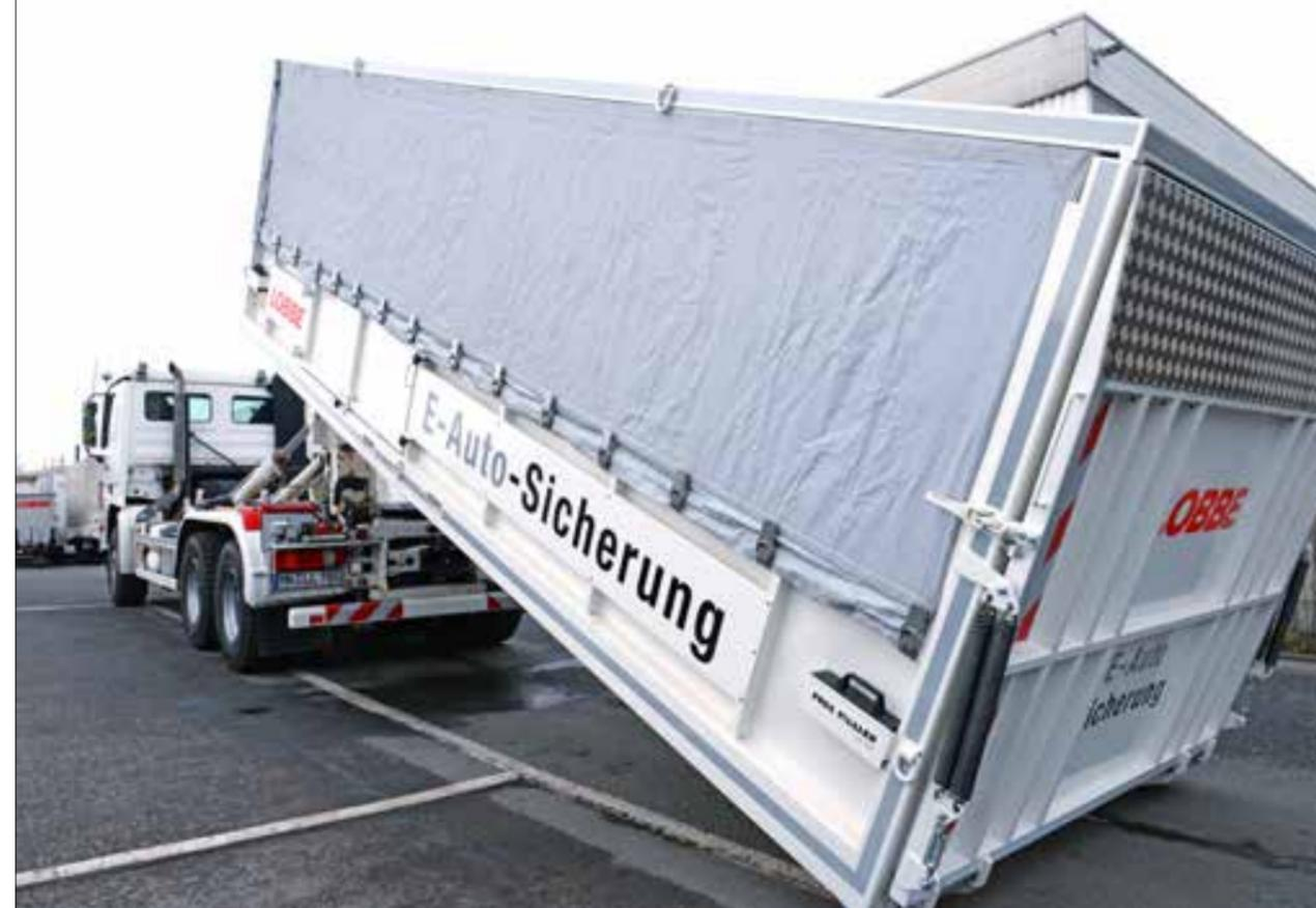
**01** Der Bergungscontainer für Elektrofahrzeuge ist der neueste Zuwachs im Fuhrpark des Lobbe-Havariemanagements. **02** Mithilfe einer Seilwinde wird das Fahrzeug in den Container gezogen.
