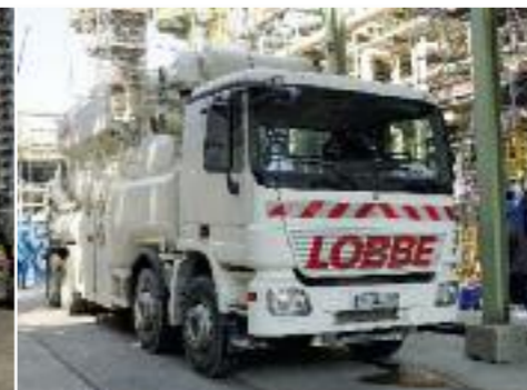
HD-Technik, Luftfördertechnik und klassische Saug/Spültechnik waren beim TRM-Stillstand ständig im Einsatz.
