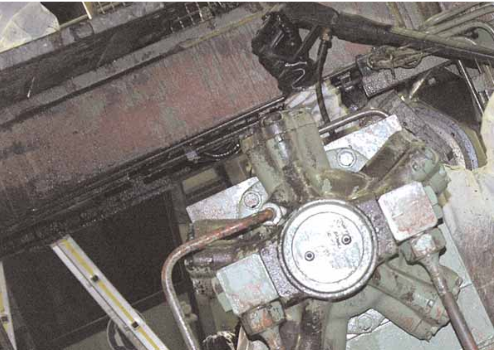
Fast wie im Akkord werden die einzelnen Maschinenteile einer Walzstraße gereinigt. Präzise geht es mit Wasserhochdruck bis hinein in den hintersten Winkel.
