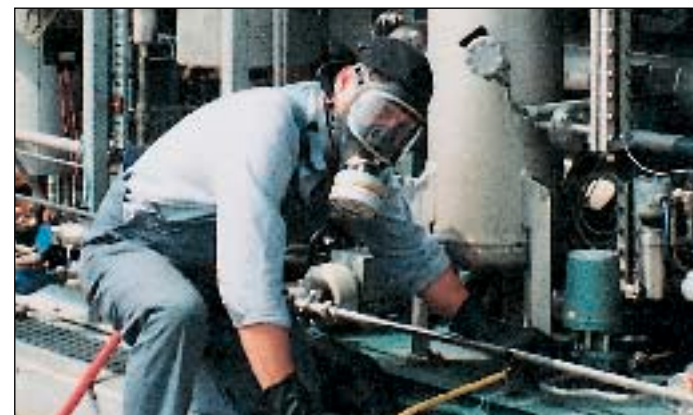
Beim Umgang mit dem Schwefelkohlenstoff mußten Atemschutzmasken getragen werden.
