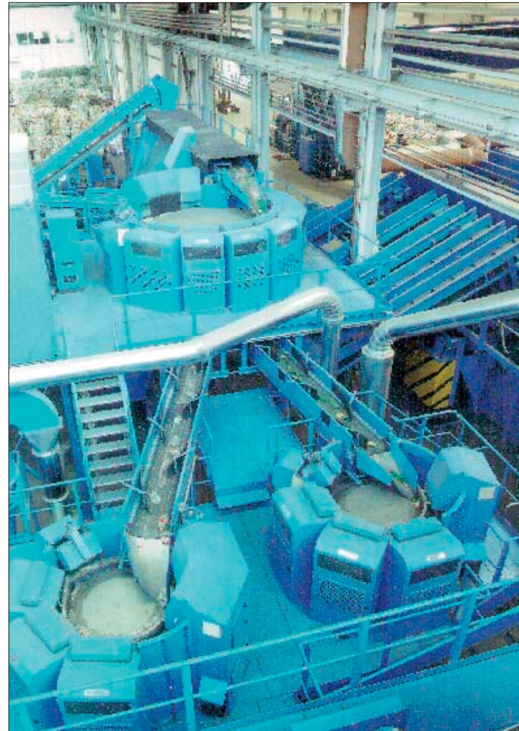
Vollautomatisch, erkennt Farben und Kunststoffarten, sortiert mit einem Reinheitsgrad von 99,99 Prozent: Die neue Sortieranlage von Lobbe in Klagenfurt.
