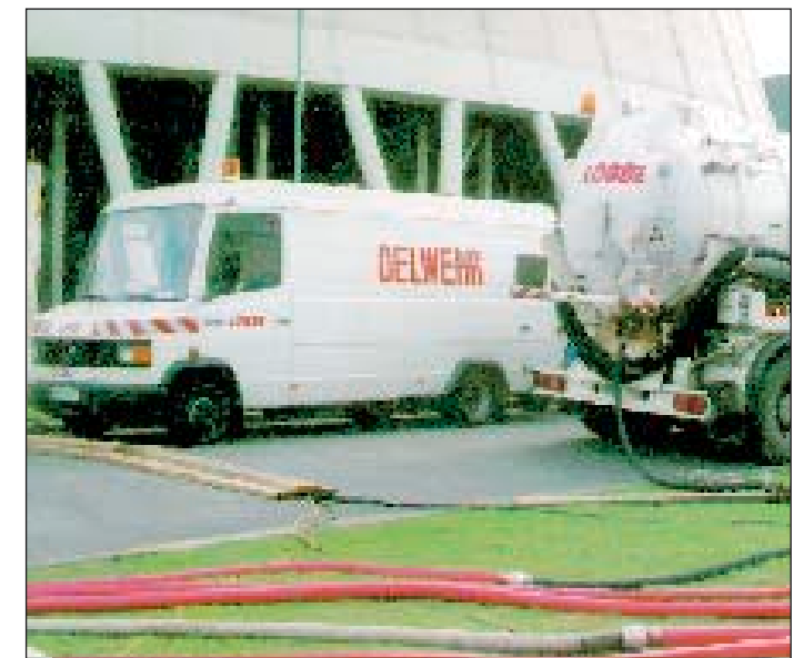
Gruß aus dem mit Heizöl verunreinigten Regenrückhaltebecken (links). Lobbe rückt gleich mit komplettem Fahrzeug-Equipment wie Ölwehrwagen und Saugfahrzeugen an.
